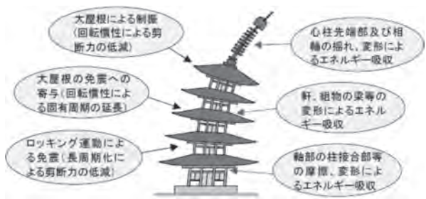
図2. 地震時の五重塔の各要素の動き
